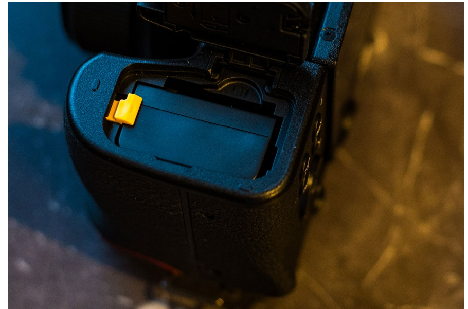
Abb. 3: Die Unterseite der Kamera bietet Zugriff auf den Akku und den SD-Kartenslot.
